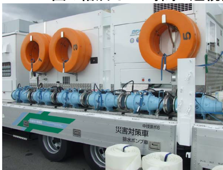
排水ポンプ (Φ200mm 5m 3 /min×12台 全揚程10m)
