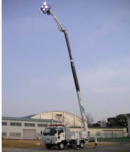
照明装置（2kW×6灯）
