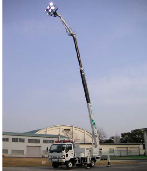
照明装置（2kW×6灯）
