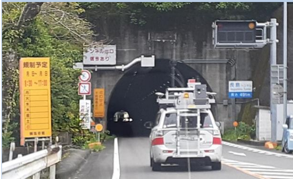
【MMSDにより3次元点群データ取得】
