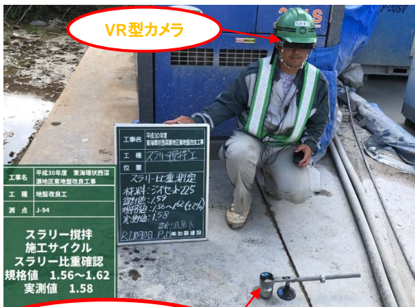
立合状況(現場) (材料検査 スラリー比重確認)
