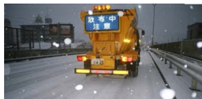
凍結防止剤散布車による通行確保
