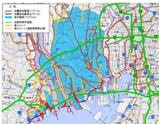
浸水想定範囲(TP+0.0m)と進入ルート、堤防仮締切区間 (A~F工区 計10km)
