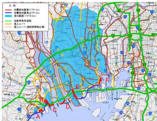
浸水想定範囲(TP+0.0m)と進入ルート、堤防仮締切区間 (A~F工区 計10km)
