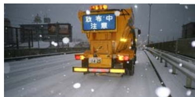
凍結防止剤散布車による通行確保
