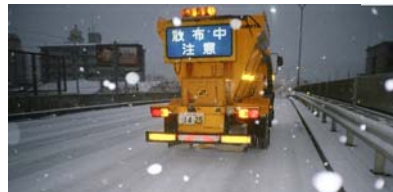
凍結防止剤散布車による通行確保
