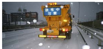
凍結防止剤散布車による通行確保
