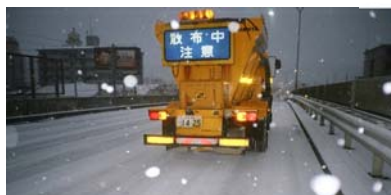
凍結防止剤散布車による通行確保
