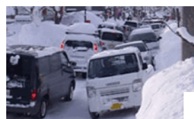
除雪が遅れ路肩の堆雪によりすれ違い困難となった事例
