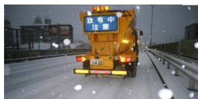
凍結防止剤散布車による通行確保
