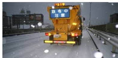
凍結防止剤散布車による通行確保
