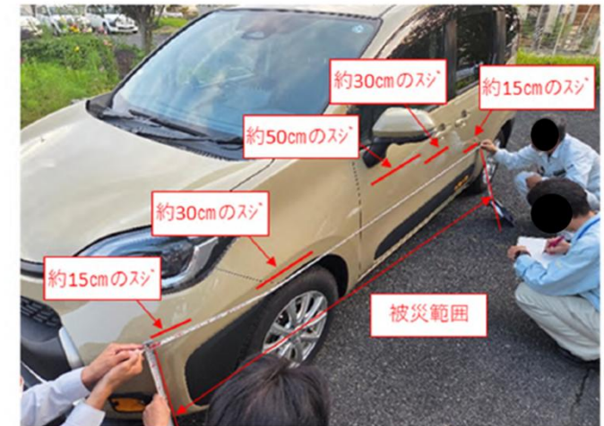
車両損傷状況写真
