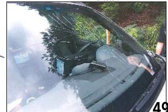
フロントガラスの損傷状況
