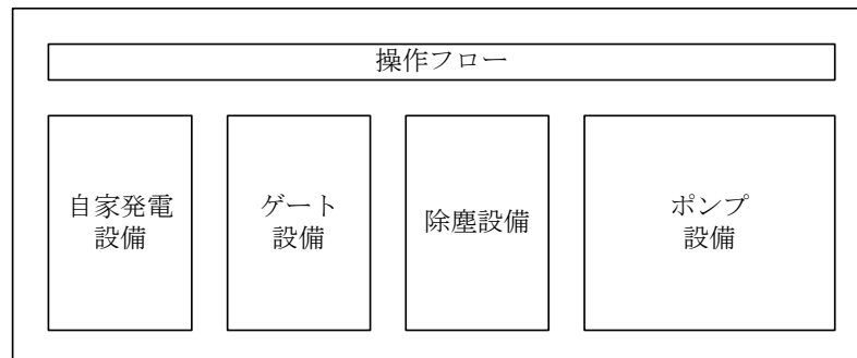
図 2-3-1 操作盤面配置
