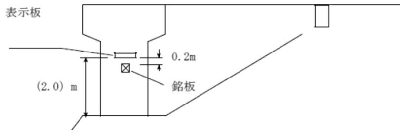
図6-3-1 橋門の銘板及び表示板の取付け場所
