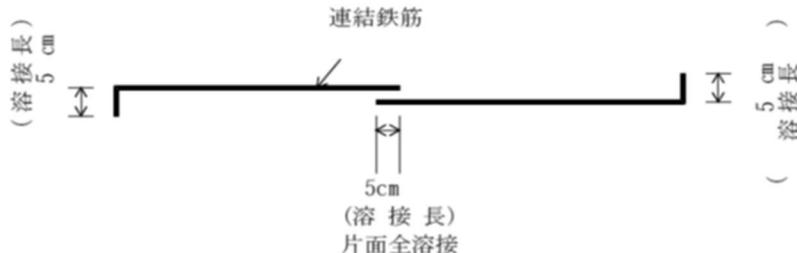
図3-2-1 コンクリートブロックの鉄筋継手
