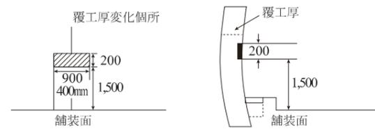
図10-6-1 覆工厚変化箇所の刻示標準図
