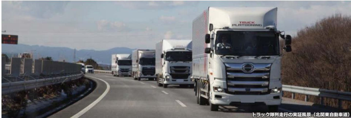
トラック隊列走行の実証風景（北関東自動車道）
