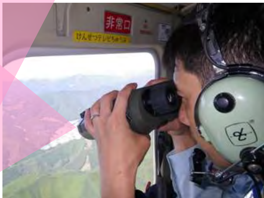
簡易レーザ計測
