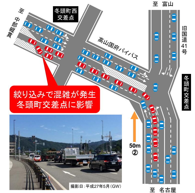
全線2車線開通後の冬頭町交差点の状況
