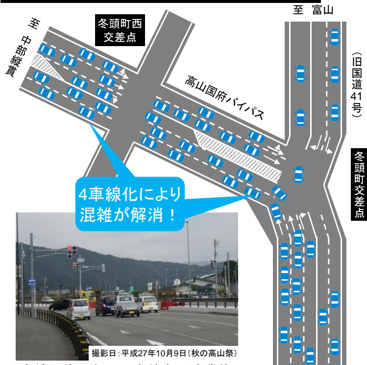
4車線化後の冬頭町交差点の渋滞状況
