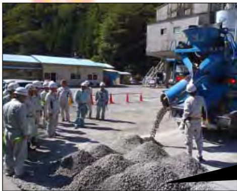
特殊薬剤投入、アジテータ攪拌後の状況
