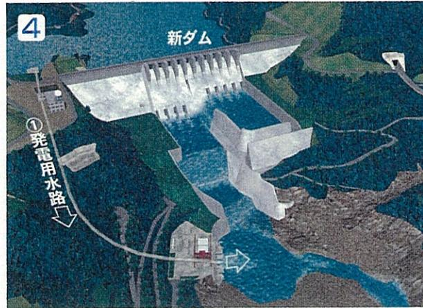
新ダムが立ち上がり、ゲート操作が可能となった段階で、既設ダムの上部及びゲートを取り壊します。その後、仮排水トンネルを埋め、新丸山ダムの完成です。
