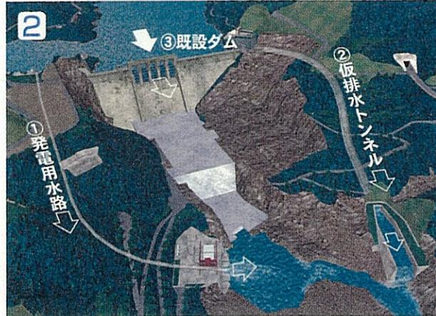
新ダムのコンクリートを順次打設していきます。出水時には、①発電用水路と②仮排水トンネルを利用して水を迂回させますが、これらで対応できない出水時には、③既設ダムのゲート操作を行い、コンクリート表面へ水を流します。
