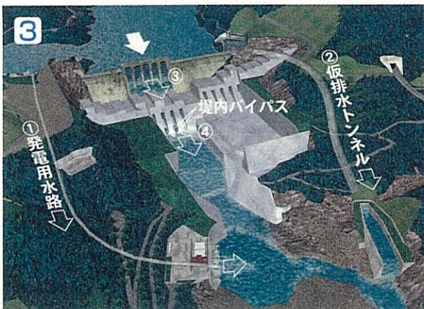
①発電用水路と②仮排水トンネルで対応できない出水時には、③既設ダムのゲート操作を行い、新ダムに設けた④堤内バイパス（空洞部）から水を流します。
