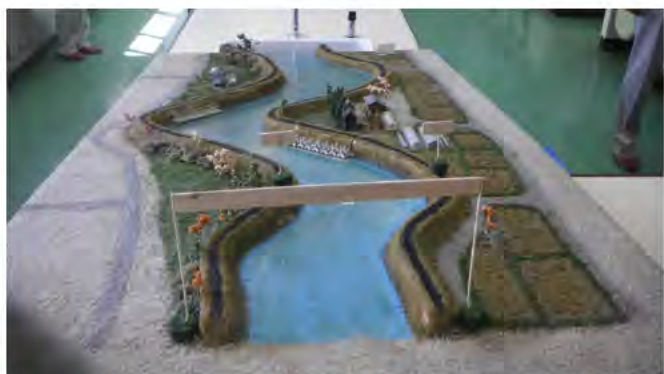
実験用の堤防模型です
