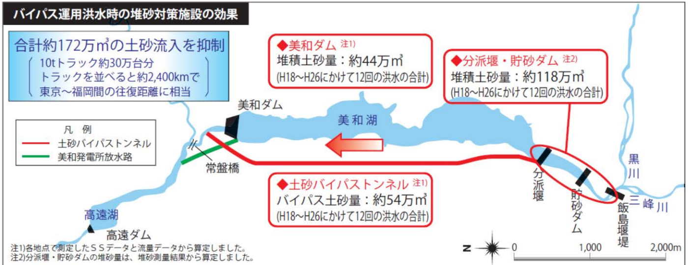
図 6：バイパス運用洪水時の堆砂対策施設の効果
