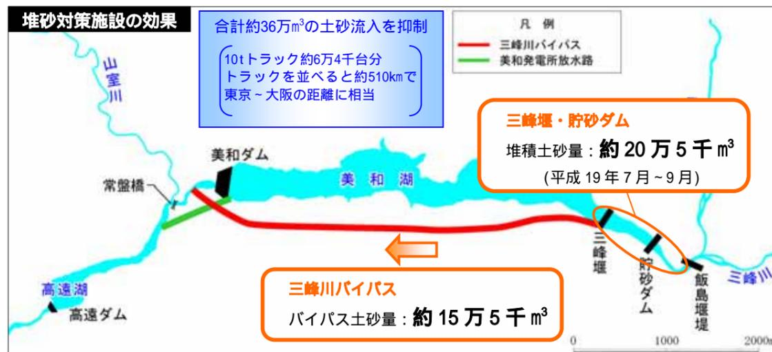
注1) バイパスを通過した土砂量は、各地点で測定したSSデータと流量データから算定しました。土粒子密度は、2.623g/cm<sup>3</sup>、空隙率は、70%を使用しています。
