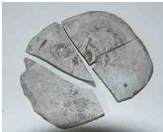
図-5 手で割れたセメント，水と混ぜてすぐに乾燥させたのもろい。
