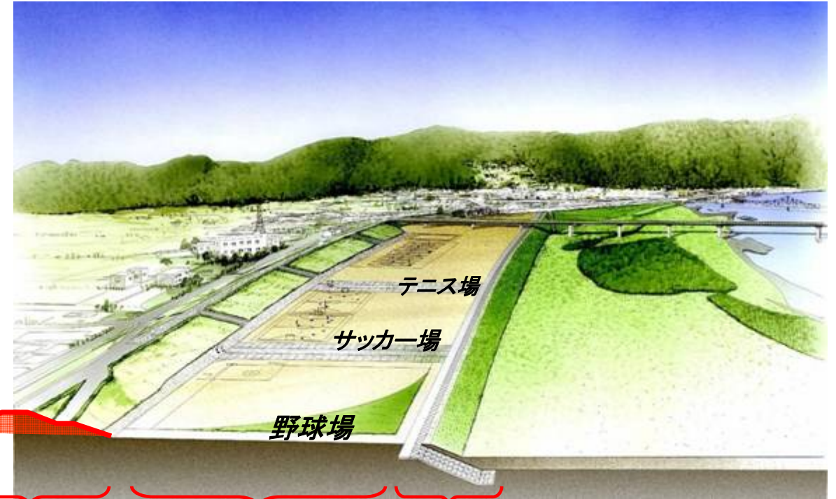
緩傾斜堤 高水敷をスポーツ公園として利用 低水護岸
